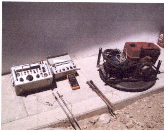
Foto No. 11.- Muestra el equipo SCINTREX empleado en el presente estudio (Aparato TRANSMISOR a la izquierda, aparato RECEPTOR al centro y MOTOGENERADOR a la derecha).
