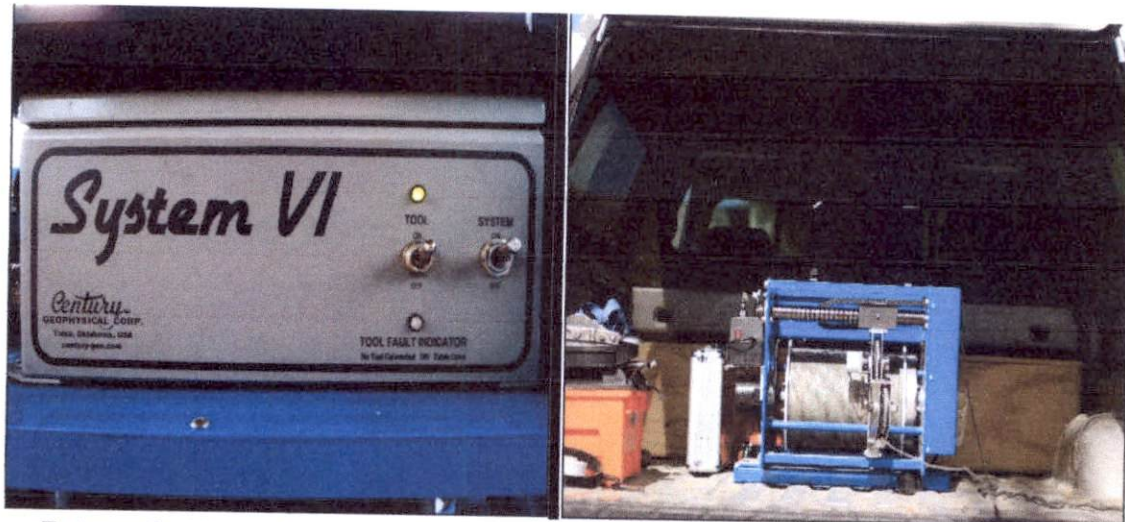
Fotografía No. 1: Equipo utilizado para la ejecución del Registro Geofísico de pozo: sonda Modelo 9144, Marca Century Geophysical Corporation.
