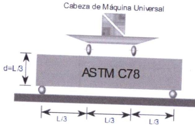
Figura 3.6 Prueba para la obtención de módulo de ruptura. En la siguiente tabla se muestra el Módulo de Ruptura (MR) recomendado.
