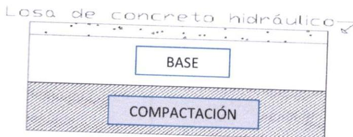
Figura 3.1. Capas del pavimento rígido.
